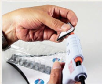
10.小さい翼を2つ折りにしてホットボンドをつけ、ペットボトルの後部に貼ります。（工程11.を参照）
